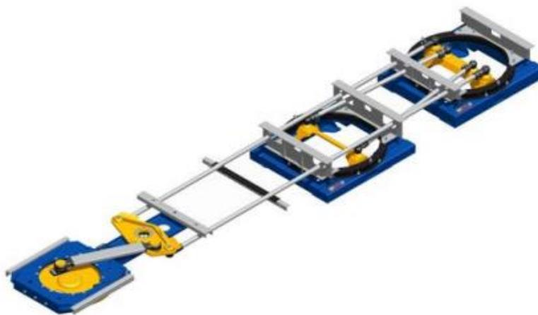
*Figura 48 - Sistema mecânico de eixos direcionais TRIDEC [26]*
